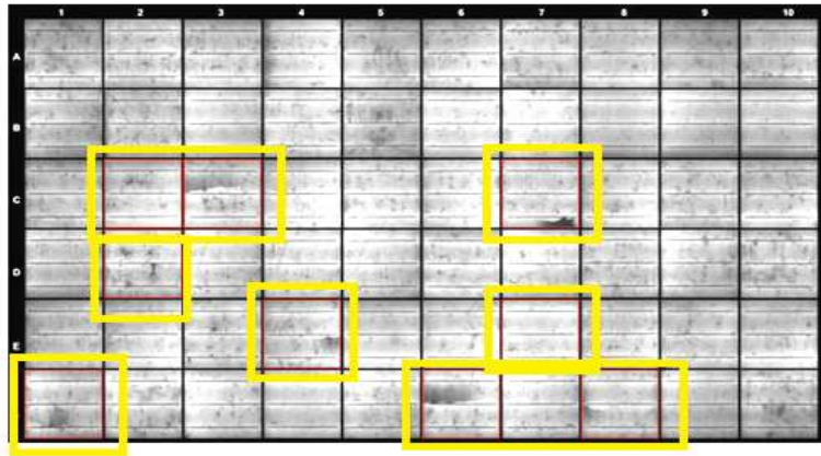
Σχήμα 64. Δοκιμή και έλεγχος ηλεκτροφωταύγειας
