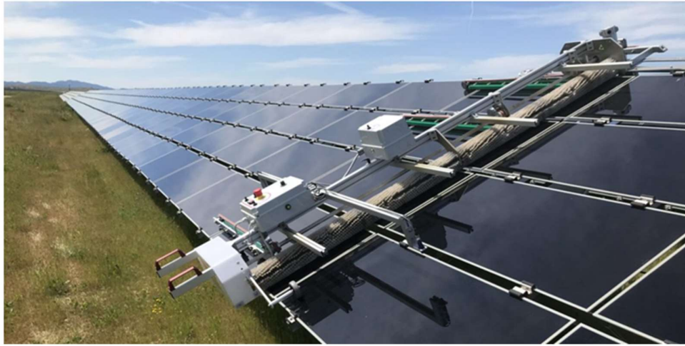
Σχήμα 56. Καθαρισμός πίνακα με ρομποτικό μηχανισμό
