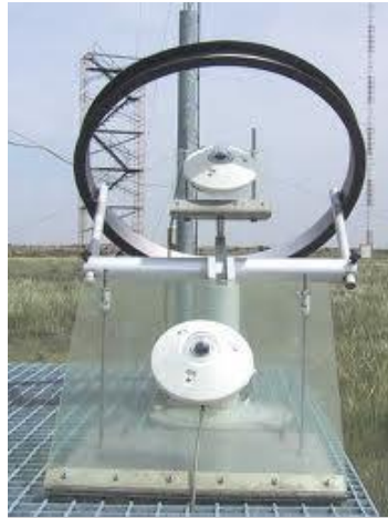
Şekil 11. Yansıma difüz ve doğrudan gelen güneş radyasyonunu ölçüm düzeneği
