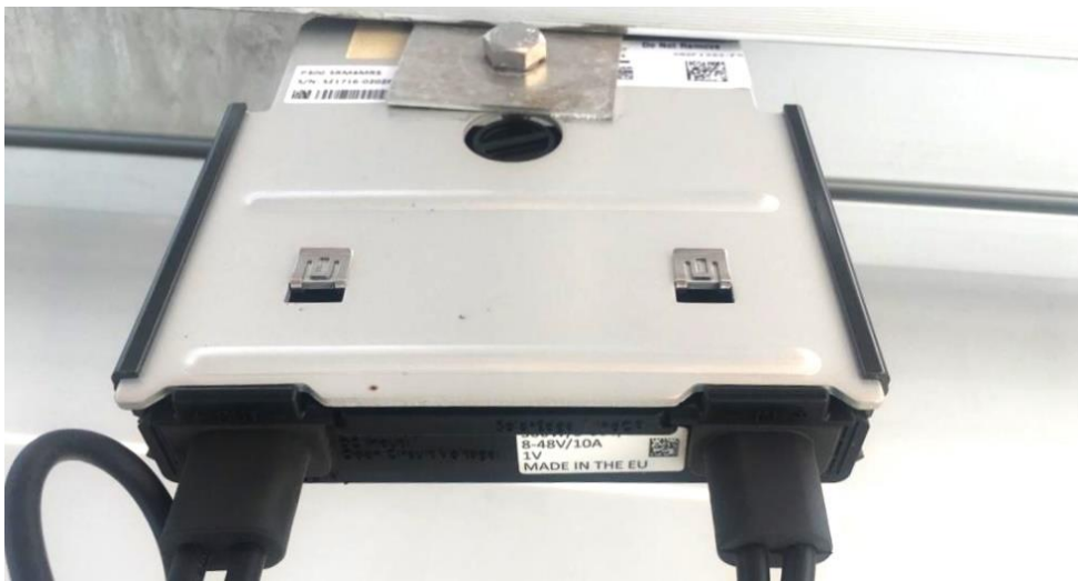
Şekil 33. Şarj kontrol ünitesi
