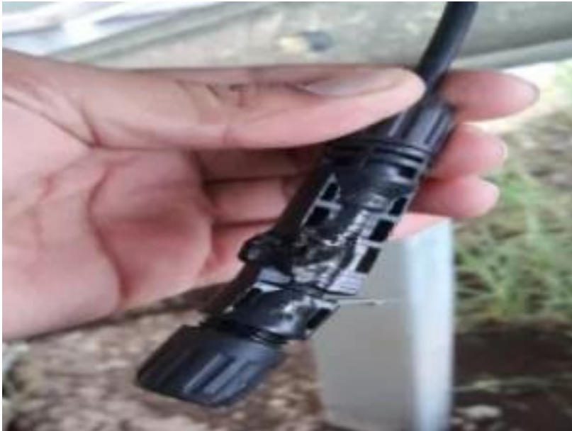
Şekil 53. Uyumsuzluk sonucu yanmış bir konnektör
